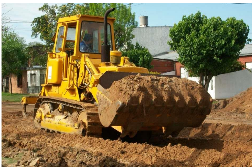
Figura 4: Cargador Frontal sobre orugas
