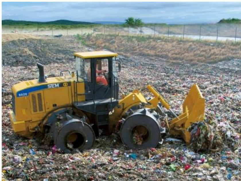
Figura 2: Compactador con ruedas metálicas
