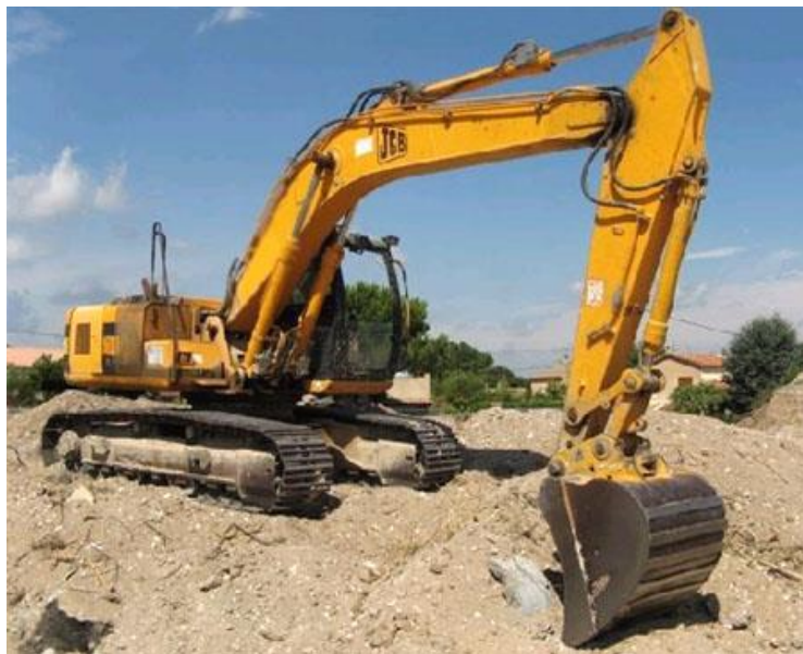
Figura 5: Retroexcavadora sobre orugas
