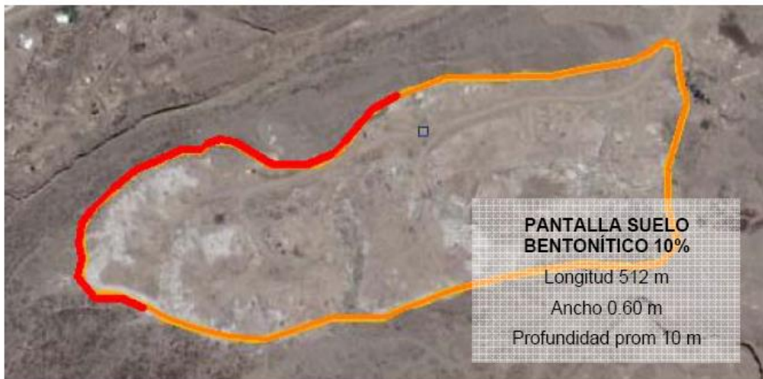
Figura 15 – Localización Pantalla de Suelo Bentonítico
